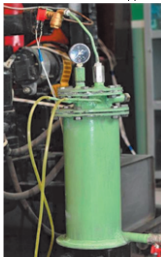
Рис. 1 Устройство для получения водорода на борту локомотива – генератор водорода
