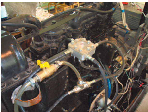
Рис. 8. Топливная система дизеля Д-242 с устройством обогащения дизельного топлива водородом
