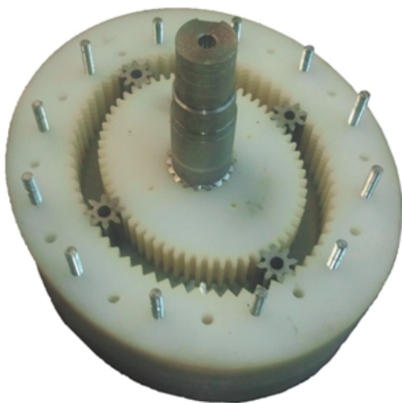
Рис. 5. Роторная гидромашина (RU 2014113740 [4]), изготовленная с применением лазерной резки
