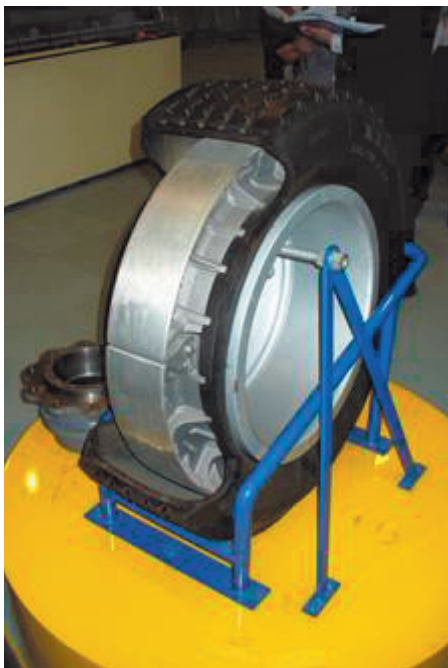
Рис. 5. Разрез колеса
