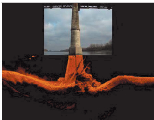
Рис. 8. Изображения опор одного из мостов в штате Айова, полученные с помощью акустических приборов. Инспекция проводилась после наводнений на Среднем Западе США в 2008 году
