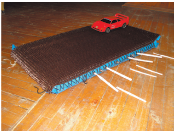
Оболочка текстопалубки изготавливается из несъёмных опалубочных текстильных материалов (НОТМ).
