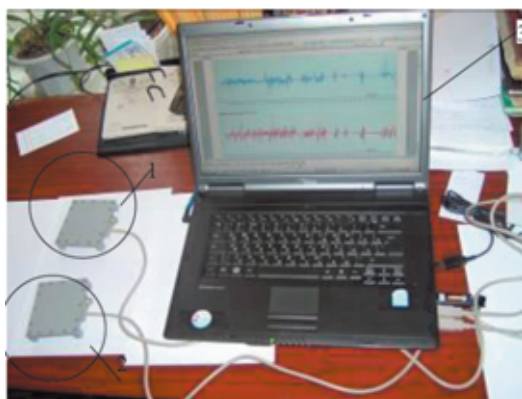
Рис. 3. Мобильный измерительный комплекс, разработанный кафедрой технологии машиностроения и ремонта машин ХНАДУ: 1, 2 – акселерометры; 3 – ноутбук
