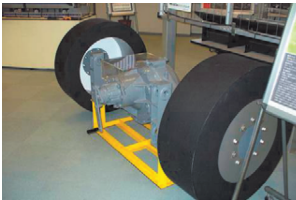
Рис. 6. Межколёсный дифференциал
