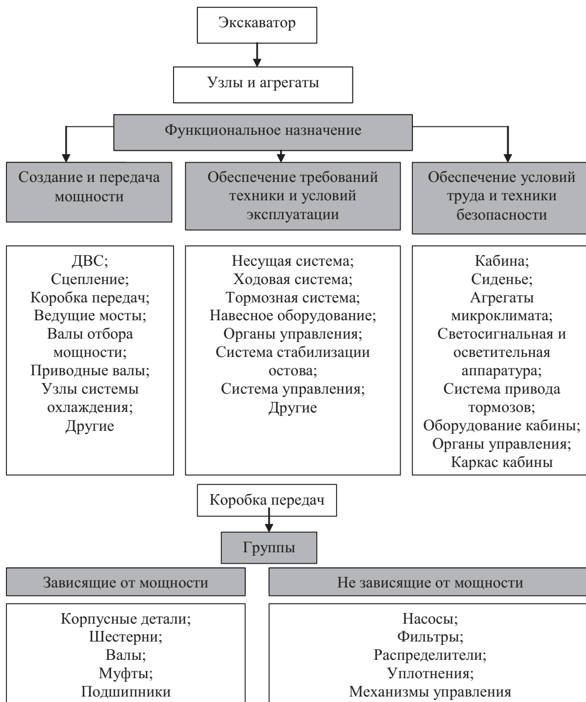
Рис. 3. Основные группы узлов и агрегатов экскаватора
