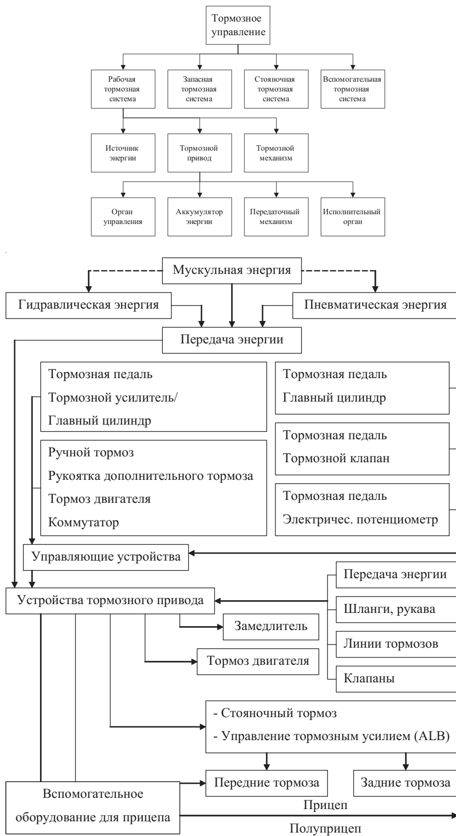
Рис. 4. Основные группы узлов и агрегатов тормозной системы автопоезда с полуприцепом-самосвалом
