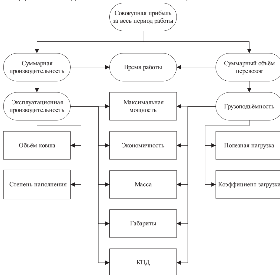
Рис. 2. Функциональная модель технической системы грузовой станции с разгрузкой полувагонов на повышенном пути
