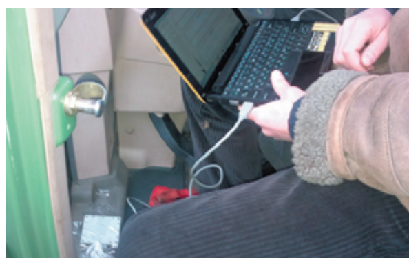
Рис. 4. Установка и настройка мобильного измерительного комплекса на тракторе Fendt 936 Vario
