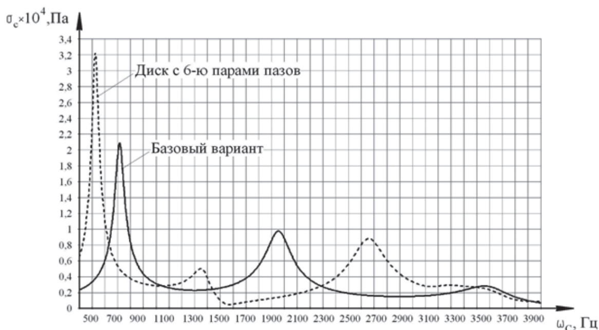
Рис. 7. Результаты частотного анализа отклика фрикционного диска
