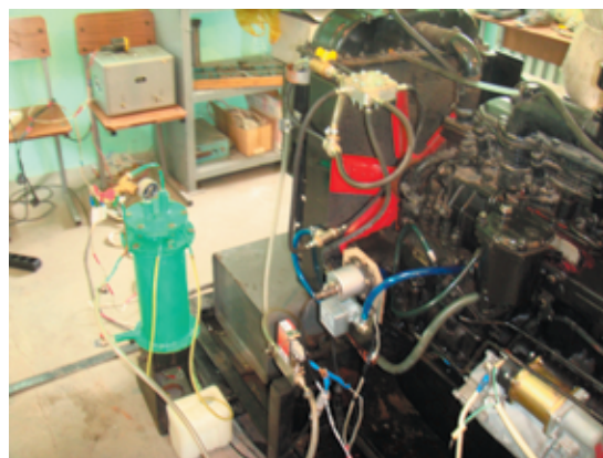
Рис. 5. Схема подключения генератора водорода и устройства обогащения дизельного топлива водородом дизеля Д-242
